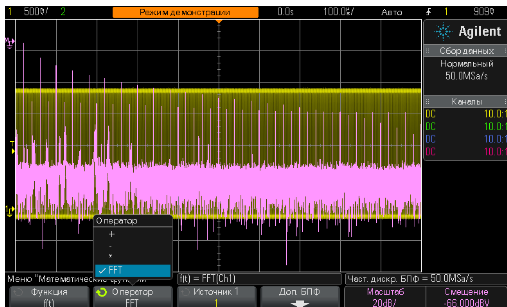
Рис. 43 Применение математической функции БПФ к повторяющемуся цифровому сигналу
